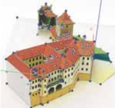
Původní (s detekcí hran a vrcholů) a finální virtuální model.
