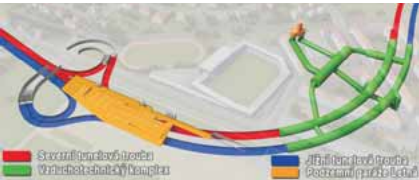
Technologické schéma tunelu Blanka s velkokapacitními garážemi v prostoru Letné.
